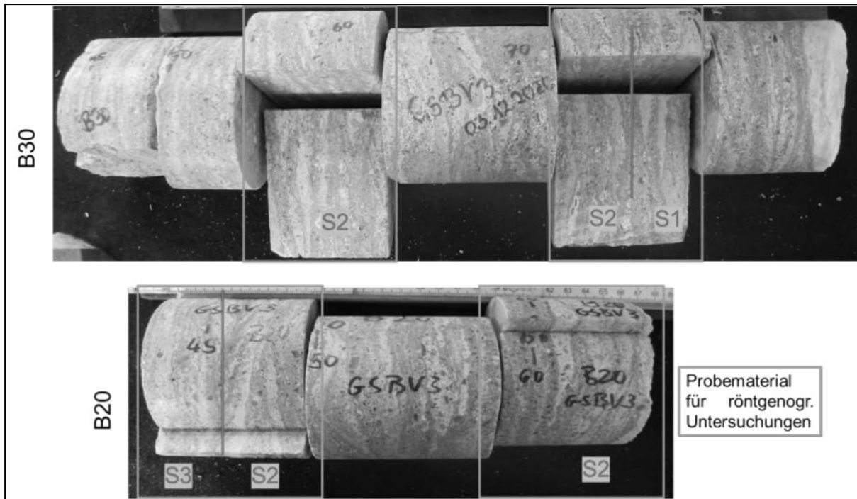
Abbildung 188: Fotos des Bohrkernmaterials der Bohrungen B20 und B30 aus dem GSBV3; S1, S2, S3: 1., 2. und 3. Betonierschicht; rote Linie: Lage BAG
