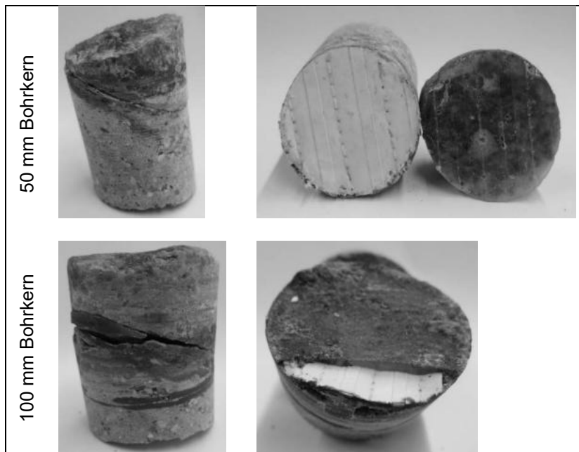
Abbildung 56: Fotos der für die dielektrischen Messungen gewonnenen Bohrkern
