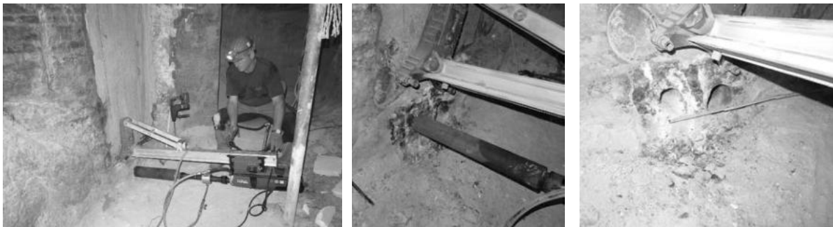
Abbildung 55: Fotos der Bohrkerngewinnung für dielektrische Messungen
