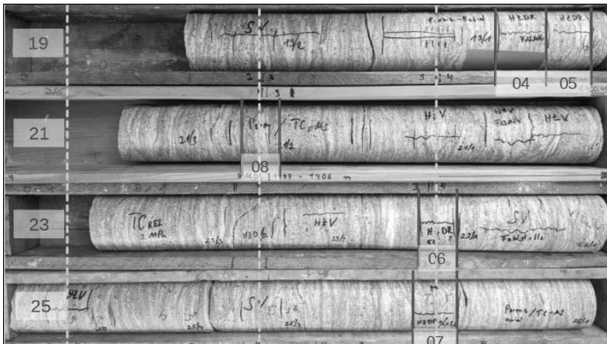
Abbildung 201: Bohrkerne GSBV3, Positionen der Proben für PET/CT-Untersuchungen. Die BAG-Zonen sind gelb markiert
