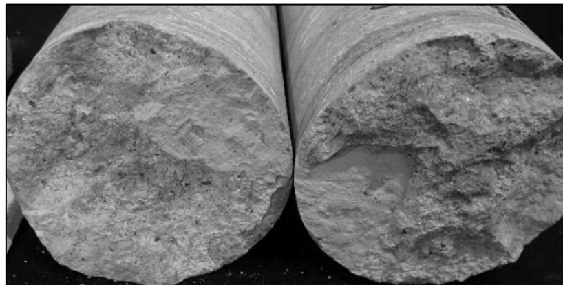
Abbildung 236: Bohrung B35 im GSBV4, Bruchfläche in 32 cm Tiefe
