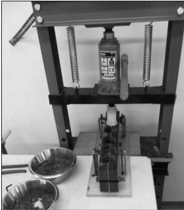
Abbildung 166: Presse zum Verdichten der Prüfkörper im Labor
