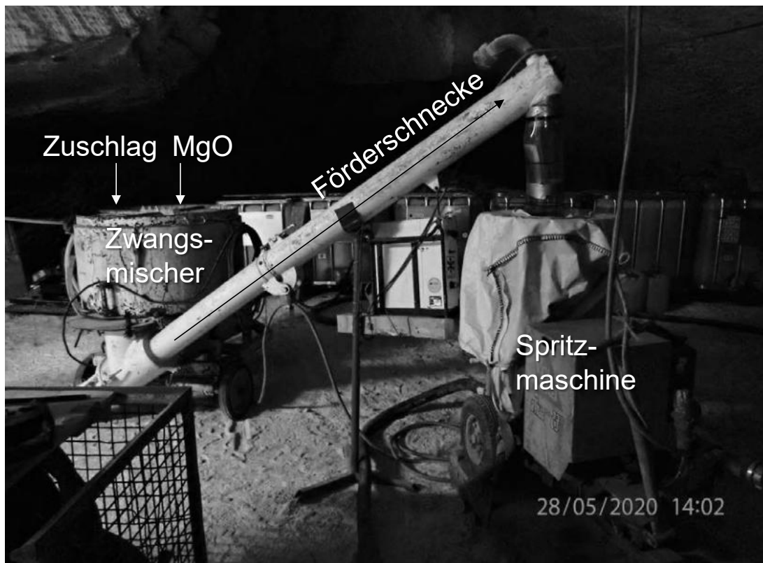
Abbildung 77: Aufbau zur Spritzmaschine
