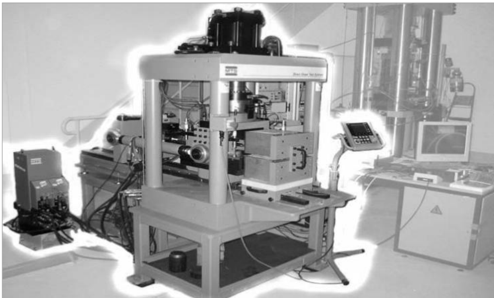
Abbildung 285: MTS-Scher-Test-System (Modell 816) (IfG Leipzig GmbH)
