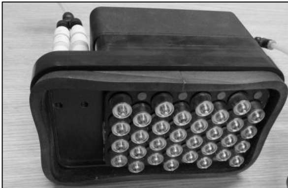
Abbildung 15: LAUS-Prüfkopf mit 32 zusammenschalteten Einzelprüfköpfen, einsetzbar als Sender oder Empfänger
