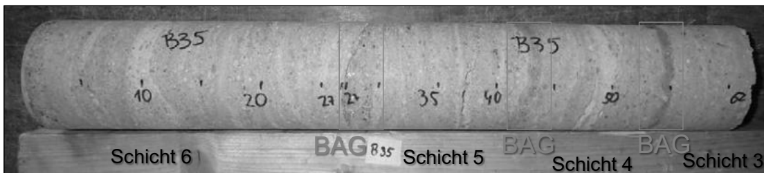
Abbildung 85: Bohrkern der Bohrung B35 aus dem GSBV1
