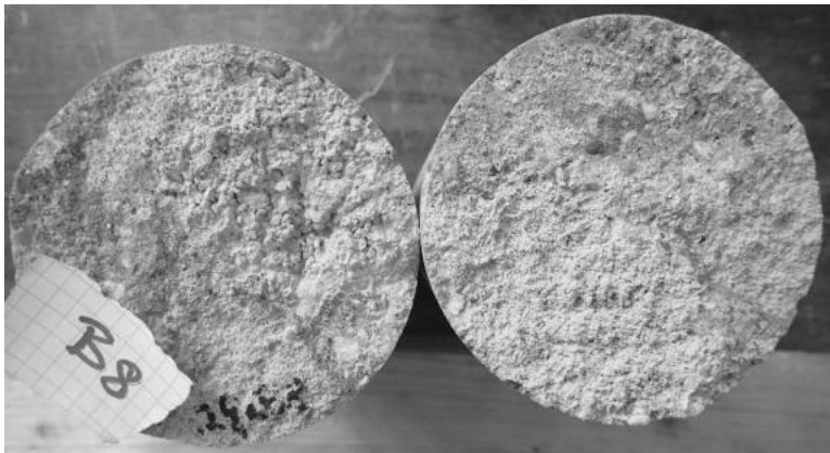
Abbildung 90: trockener Bereich an einer Bruchfläche der B8
