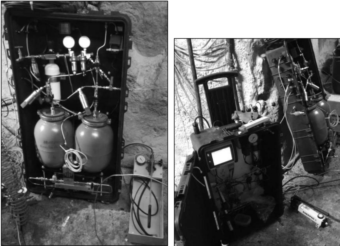
Abbildung 28: Verwendete Versuchsausrüstung für die Testung der Bohrung B45 mit MgCl 2 -haltiger, NaCl-gesättigter Lösung im Teufenbereich 0,43 m bis 2,36 m
