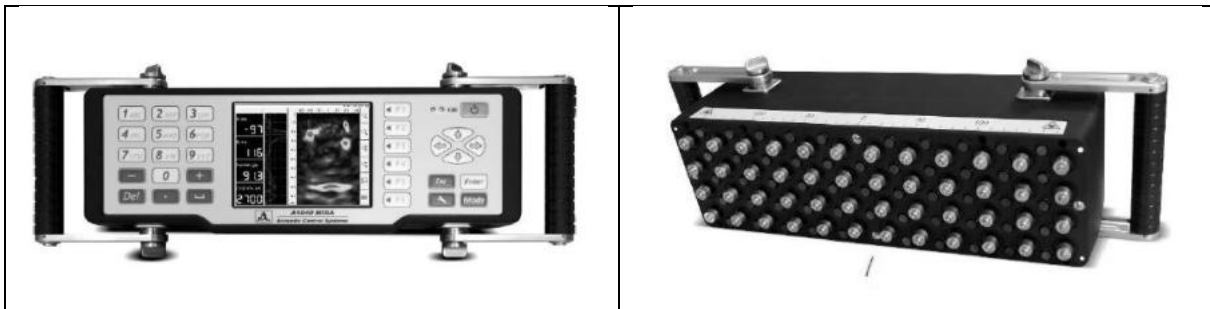
Abbildung 213: MIRA-System Bedienfeld und Bildschirm (links) und Transversalwellen-Prüfköpfen (rechts)
