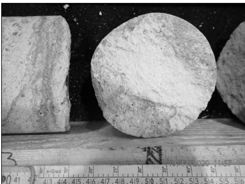
Abbildung 111: Bruchfläche mit trockenem Bereich am Bohrkern B3 des GSBV3
