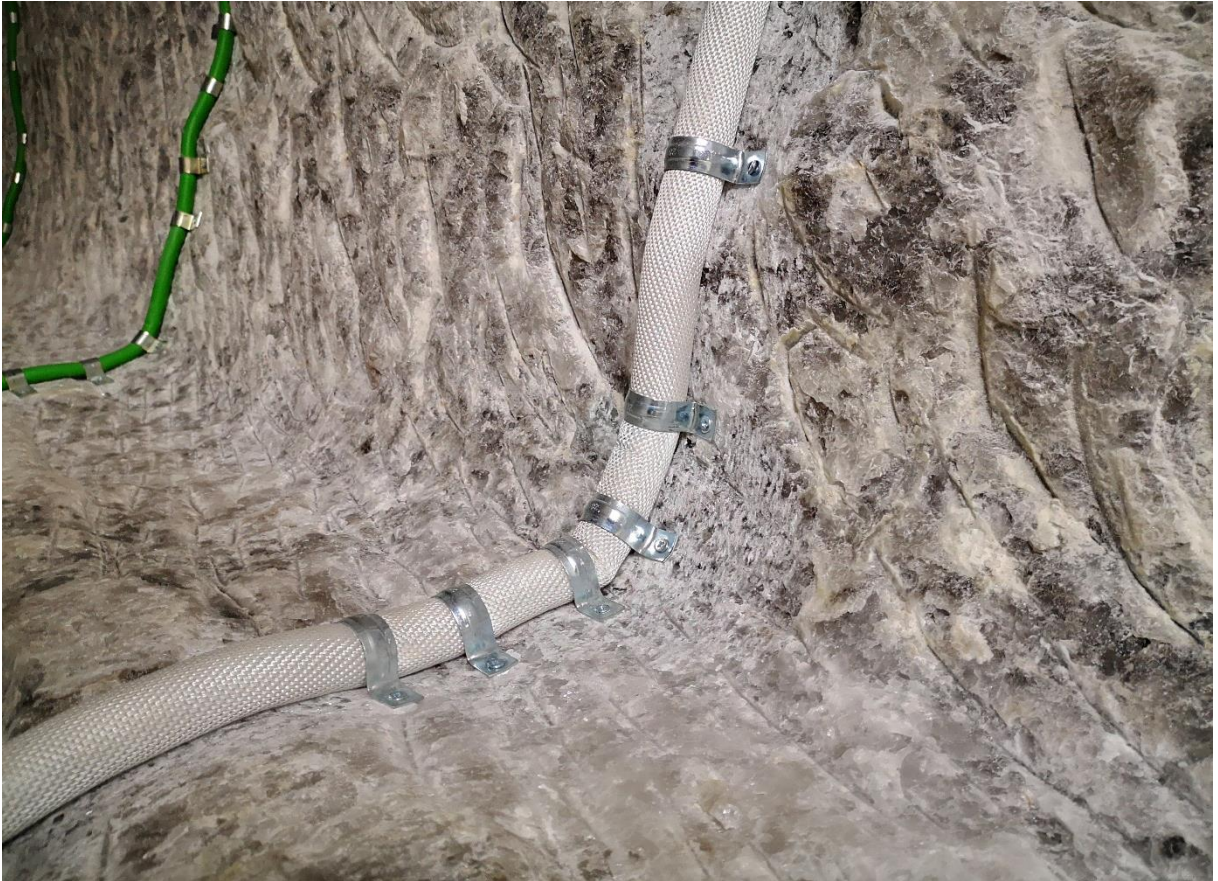
Abbildung 43: Kontakt der Ringkammer an der geglätteten Kontur
