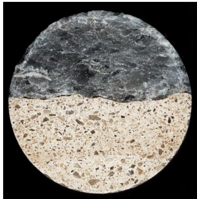
Abbildung 102: P300-46 Bereich Mitte Sohle – mäßig bearbeitet
