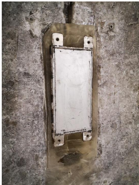
Abbildung 32: Freigelegter Druckaufnehmer nach Verguss und Bearbeitung
