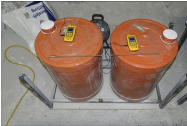
Abbildung 65: Beispielbilder quasiadiabatisches Kalorimeter
