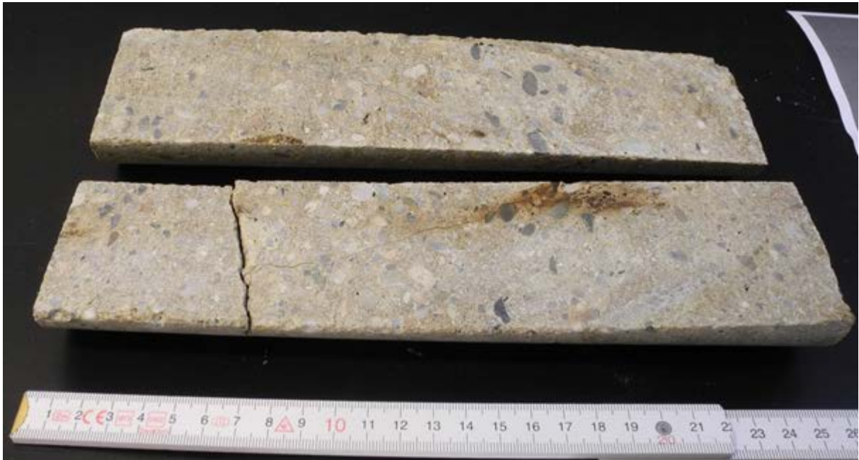
Abbildung 25: Kernstück mit Riss nach achsenparalleler Halbierung (B41 Kernfoto)
