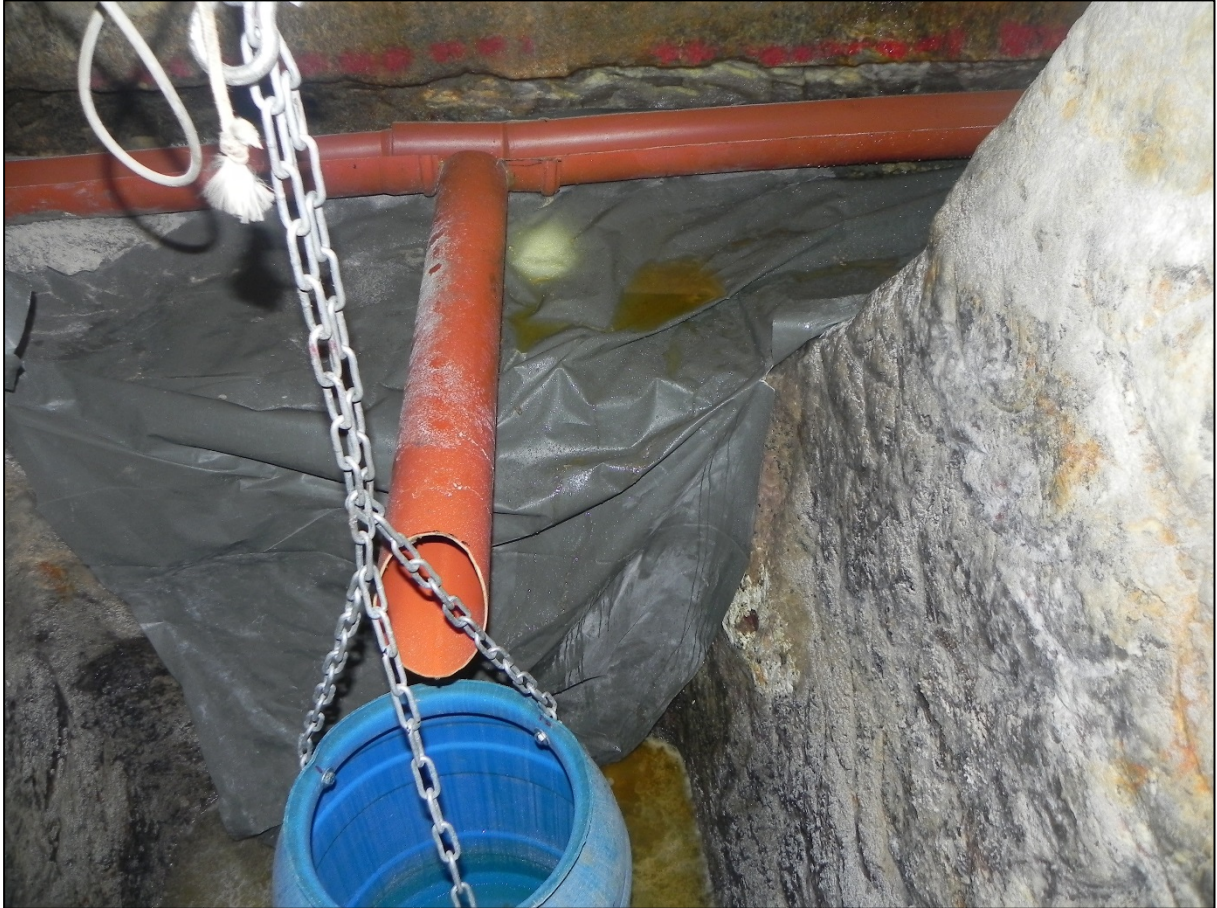
Abbildung 115: Auffangrinne und Wägeeinrichtung zum Erfassen der durchgetretenen Lösungsmenge
