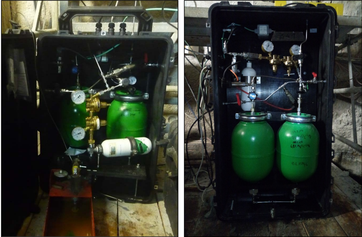
Abbildung 71: Mobile Druckregelanlagen für einen Lösungsangriff mit konstantem Druck
