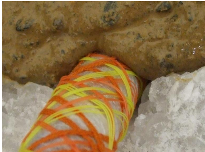
Abb. 57: Anbindung der Injektionsleitung an den Kontaktbereich zwischen Beton und Salzkern
