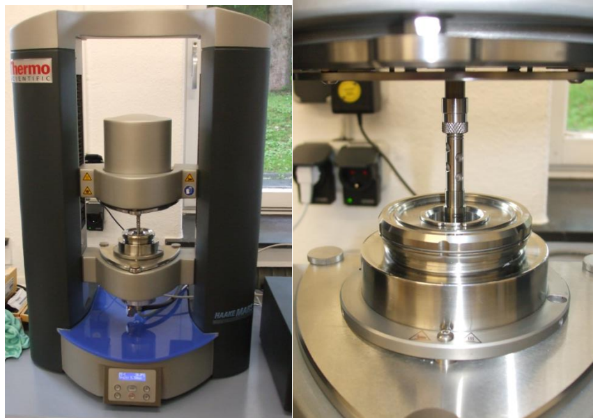
Abb. 32: Links: Rheometer Haake Mars III der Firma Thermo Scientific. Rechts: Detailaufnahme der Temperier Einheit sowie des Probenbechers und des Titandrehkörpers.
