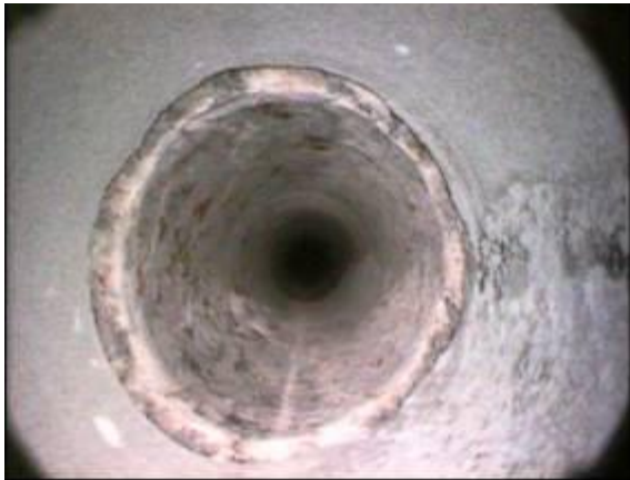
Abb. 70: Aufnahmen von offenen Kontaktbereichen zwischen Baustoff/Gebirge
