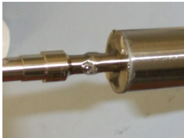
Abb. 42: Anhaftungen von vergeltem Wasserglas am Drehkörper des Rheometers
