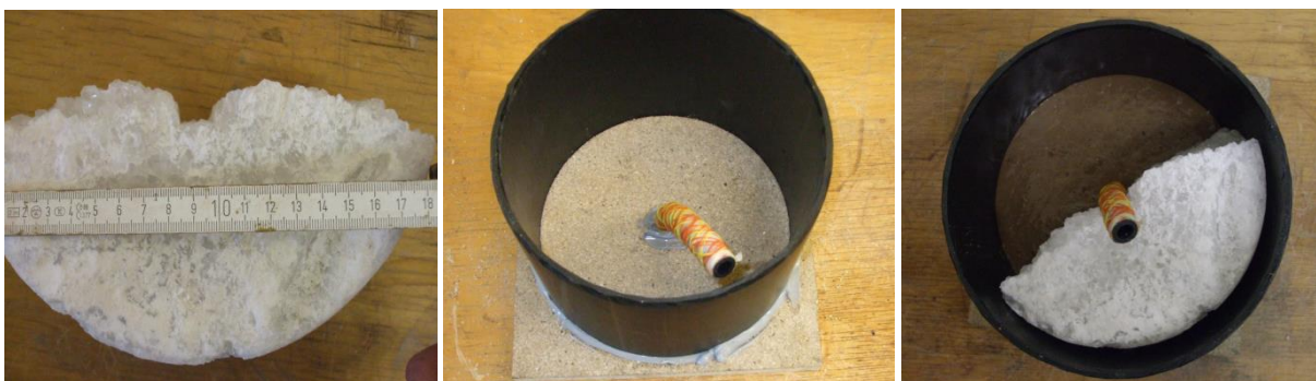
Abb. 56: Links: Halbierter Salzkern mit gesägtem Kanal. Mitte: In der Verschalung fixierte Injektionsleitung. Rechts: Halbierter Salzkern mit der im Kanal verlegten Injektionsleitung während des Gießens des Betons
